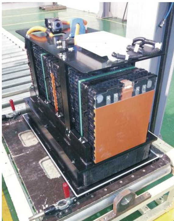
Eine Lithium-Eisenphosphat-Batterie für die neuen BYD-Flurförderzeuge
